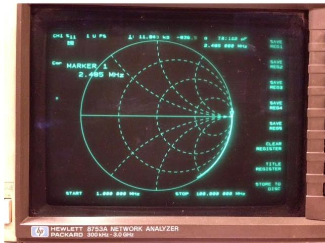
Mesure de la fréquence d'auto-résonance (SRF) de la bobine à 16 tours. La bobine est parallèle à la charge de 50 ohms, donc pas de câbles, pour minimiser l'effet de la capacité du câble sur SRF. Voyager le dip dans S11.
