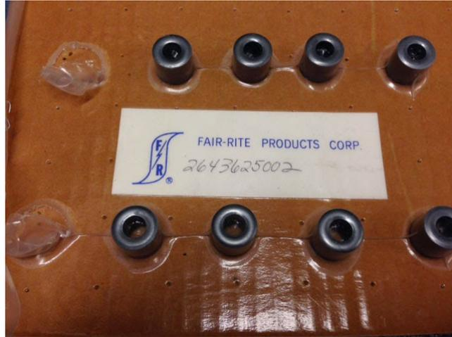
Notez qu'ils sont en ferrite, et non pas en poudre de fer ( le lien à la datasheet est à la fin de ce post). Selon l'article QEX de N8LP (voir le lien à la fin), les noyaux de ferrite sont plus sujets à la saturation que les noyaux de fer en poudre. Je ne sais pas quelle puissance ces noyaux vont accepter - je vais devoir expérimenter.
